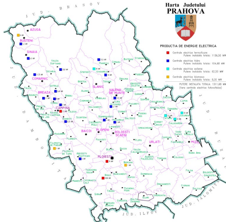
Figura 5.4 Harta localizării centralelor electrice (excepție fotovoltaicele), Prahova 13 (2016)
